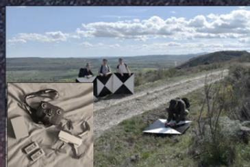
Figura 1. Colocación puntos de control y dron utilizado
